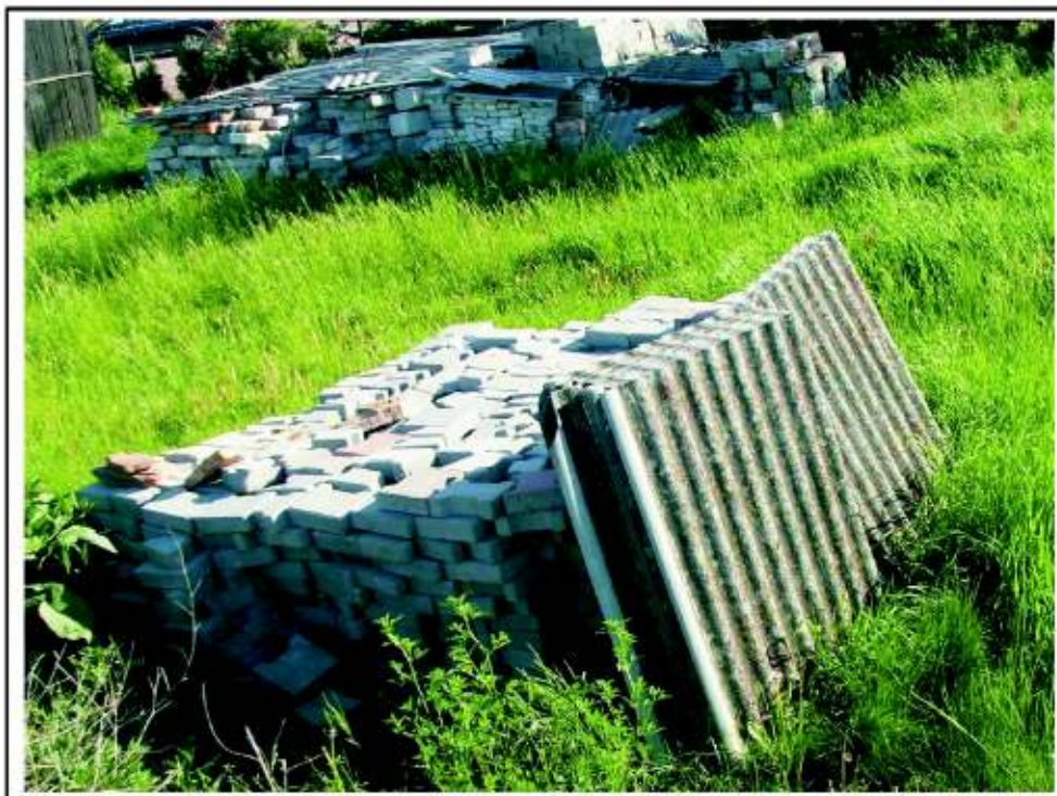
Fot.5 Płyty faliste złożone na terenie posesji - I stopień pilności
