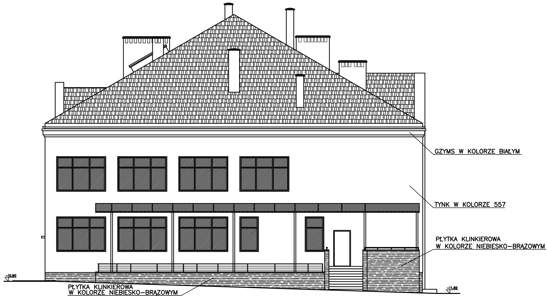
ELEWACJA PÓŁNOCNO-WSCHODNIA SKALA 1:100
